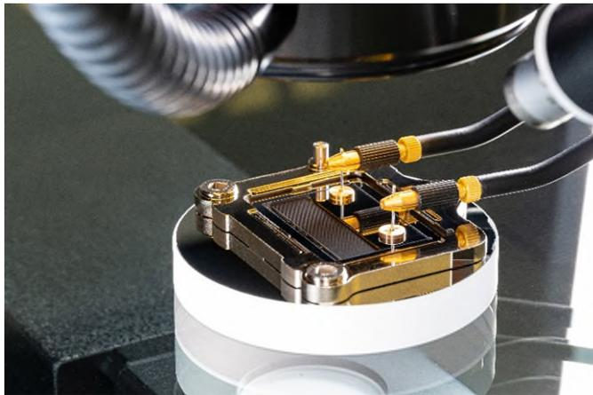
**Abb. 1** Doppelspaltbaugruppe während der Präzisionsmontage in der Koordinatenmessmaschine.
